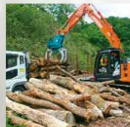
グラブによる積込作業
