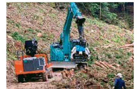
R2導入の新型フォワーダ。令和のリュウシン号第1号機。後ろにはリース機のプロセッサ。このセットで1日40~50m³造材、搬出しています。
