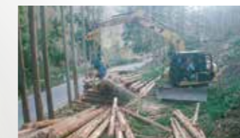
ハーベスタによる造材作業
