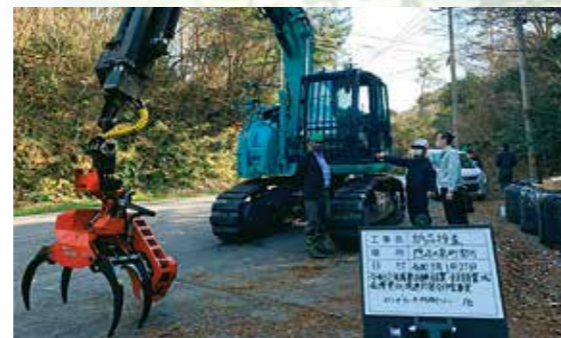
R2導入したロングリーチ伐倒ソー。(15m,最大伐倒径60cm) 中四国では初の導入です。
