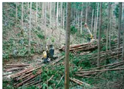
間伐木をスイングヤーダにより集材。 ハーベスタによる造材作業により間伐材を生産(間伐作業)
