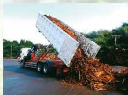
30m3コンテナトラック
