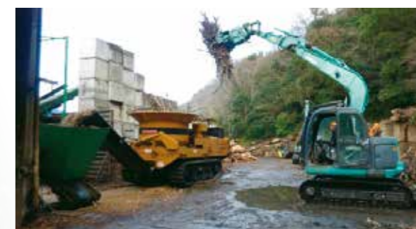
移動式チップパーによるバイオマス発電用チップの生産作業
