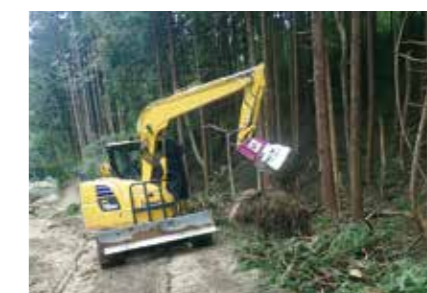
フェラーバンチャザウルスロポによる林地残材処理
