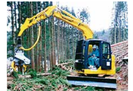
伐採・枝払い作業中
