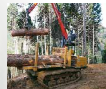
フォワーダ運材作業
