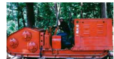
集材機による集材作業
