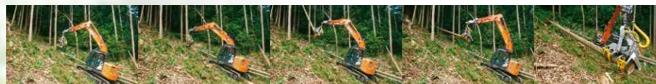
高性能林業機械による伐採作業【可能な限り、高性能林業機械による伐採・造材・地拵え作業を実施】
