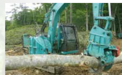
グラブプルによる造材作業
