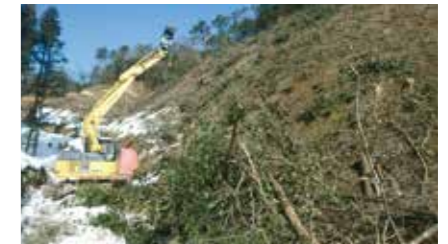
スイングヤードによる集材作業
