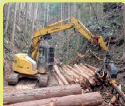
高性能林業機械ハーベスタによる 4m材原木の生産作業
