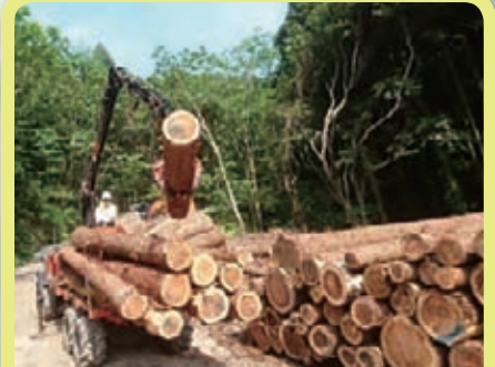
小型(2t)だが足の速いホイールフォワード。1日当たり約25m3の搬出も可能。クロータイプも導入予定
