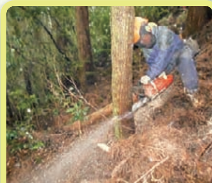
チェーンソーによる伐倒作業
