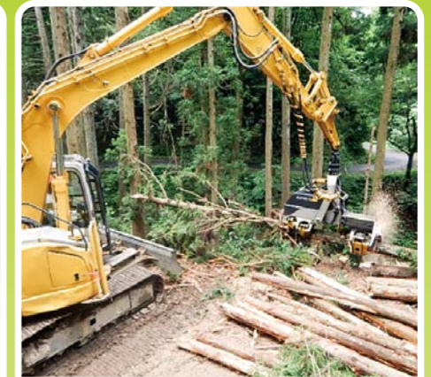
ハーベスタによる伐木造材作業
