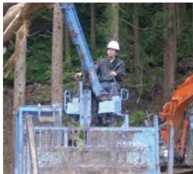
チェーンソーで伐木した材をスイングヤーダで集材している。
