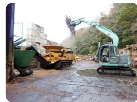
移動式チッパーによる バイオマス発電用チップの生産作業
