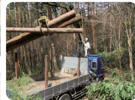
グラップルでの積み込み作業
